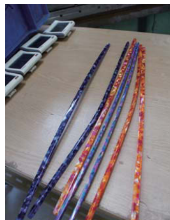
熱をかけて柔らかくしたスティック状の素材を型にはめます。
