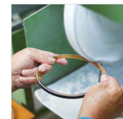
⑥更に細かい研磨材で光沢を出します
