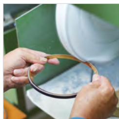
⑥更に細かい研磨材で光沢を出します
